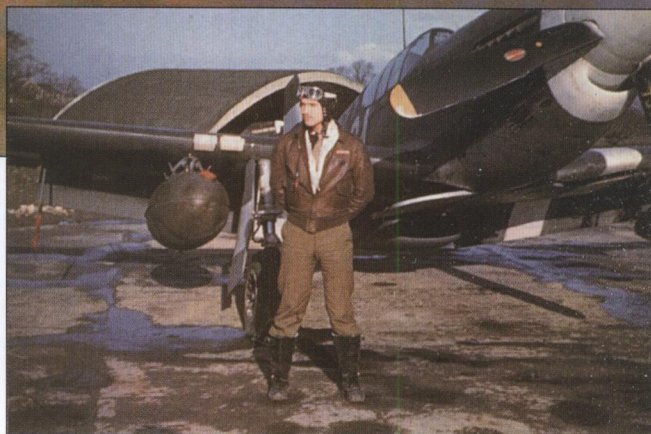
Март 1944 г. Под крылом P-51В висит подвесной бак, позволяющий достигать Берлина с территории Англи
