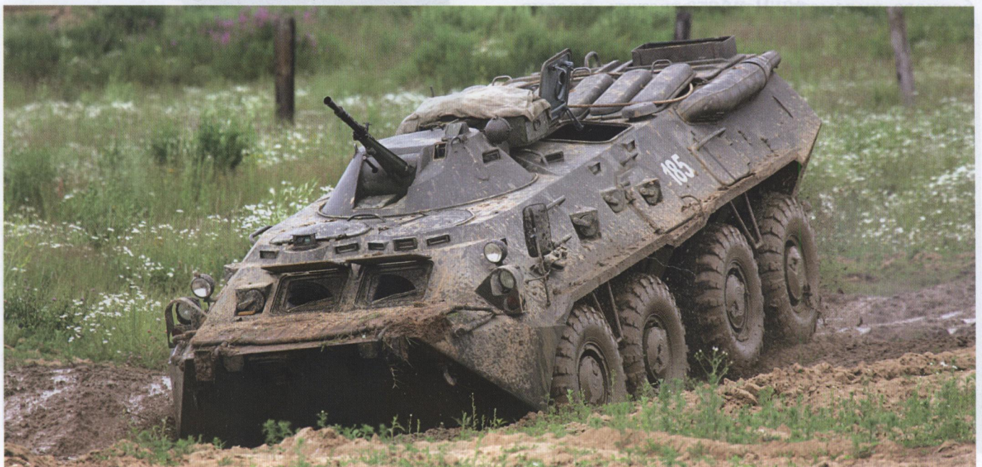
БТР-80 получил доработанную башню, позволяющую вести зенитный огонь по вертолетам и самолетам
