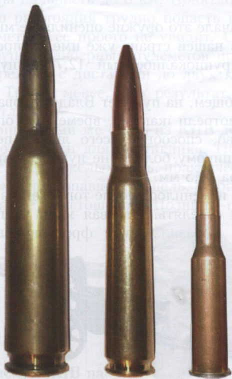
Сравнительные размеры патронов калибра 14,5-мм, 12,7-мм и 7,62-мм
