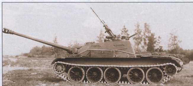
122-мм самоходное орудие Су-122-54 вооружалось также двумя пулеметами КПВТ: зенитным и спаренным с пушкой
